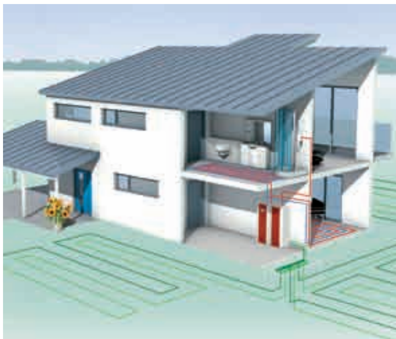
Brine / Vand Varmepumpe med jordvarme samler
