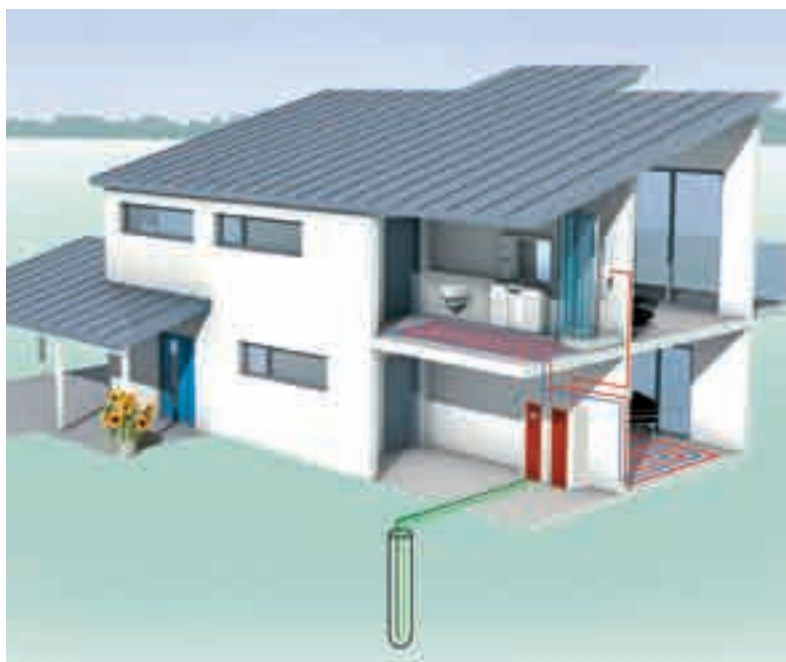
Brine / Vand Varmepumpe med brøndanlæg
